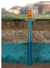
Un piézomètre est un forage non exploité qui permet la mesure la " hauteur piézométrique " en un point donné d'un système aquifère, en indiquant la pression en ce point. Il donne l'indication d'un niveau d'eau libre ou d'une pression.
